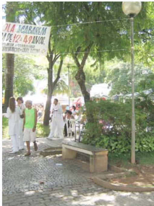
Foto34: Praça Tiradentes - Vista exemplificadora do estilo dos canteiros da praça (lado esquerdo em relação ao sentido da Av. Getúlio Vargas). Mostra o canteiro e a maneira de instalação dos bancos em torno deste. Evidencia a tipologia formal e volumétrica dos dos bancos da praça. Mostra o pisoteamento da grama. Teófilo Otoni. Ano:2007. Fotógrafa: Karine Guimarães Berbari
